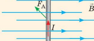
Рис. 11.1. Залежність значення сили Ампера від орієнтації провідника в магнітному полі
